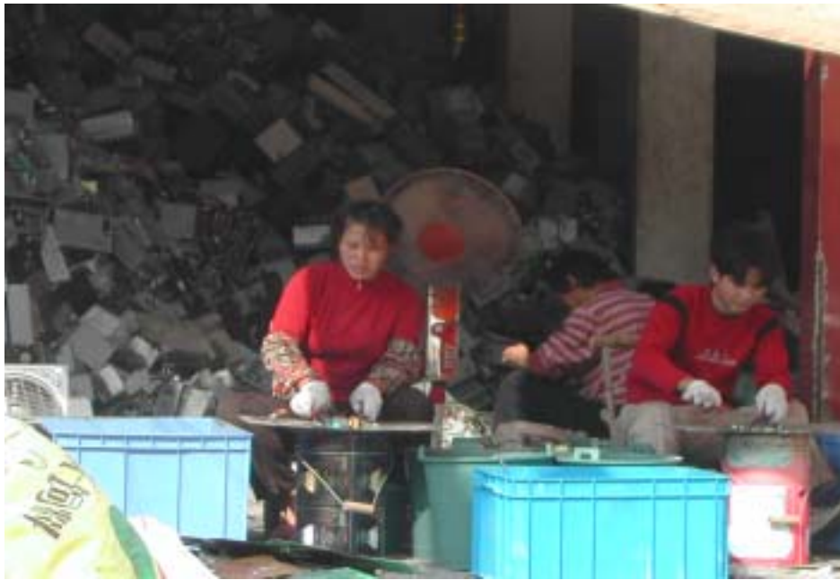
工人在王水酸液中由電路版上提取金© BAN 來源：綠色和平，貴嶼地區電子廢物處理現狀調研報告，2003 年
