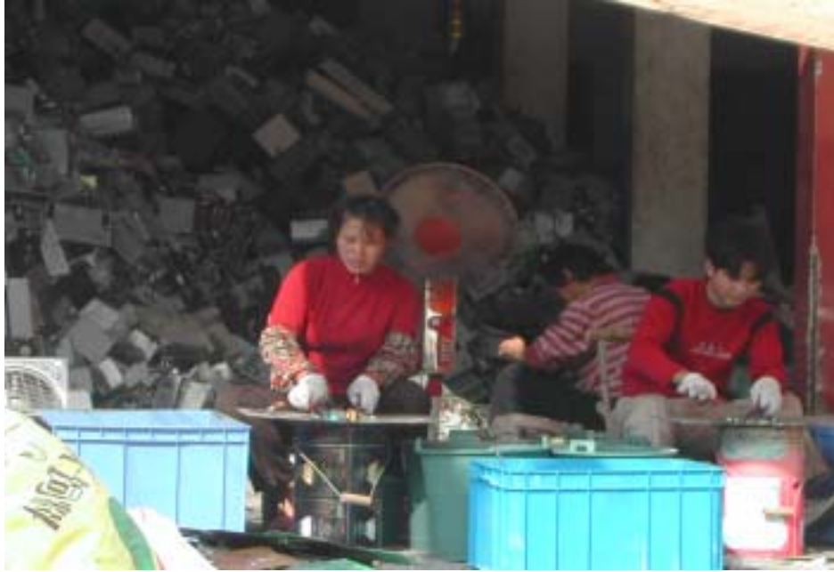
工人在王水酸液中由電路版上提取金© BAN 來源：綠色和平，貴嶼地區電子廢物處理現狀調研報告，2003 年
